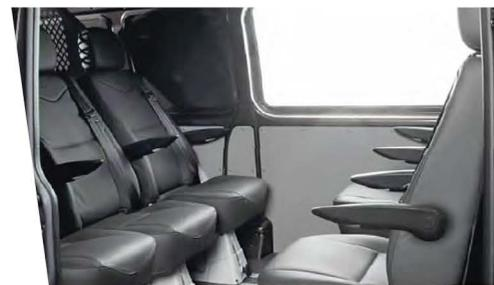
Aménagement d'intérieur d'un fourgon en «cabine approfondie», afin d'augmenter la capacité de transport grâce à l'installation de banquettes.
